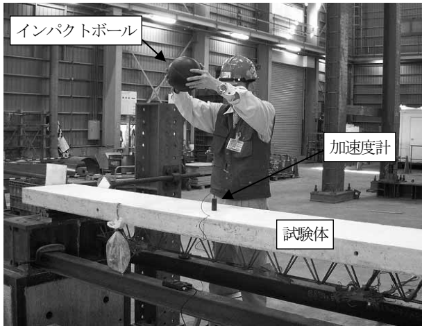
写真-2 振動計測状況
