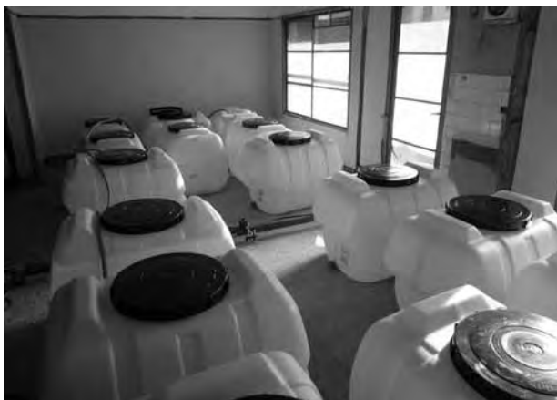
写真-4 給水タンクによる載荷状況
