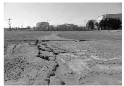
写真-27 農地の大量の噴砂, 電柱の傾斜
