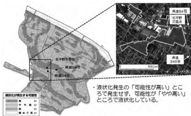
図-15 旧大利根町液状化予測マップ 16 と液状化地点の比較
