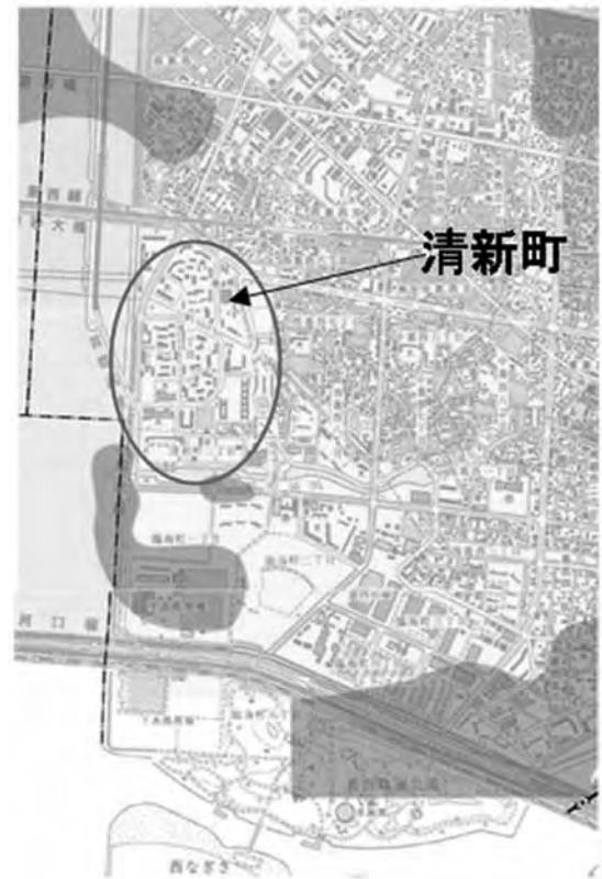
図-6 東京低地の液状化予測図 8) と液状化地点の比較
