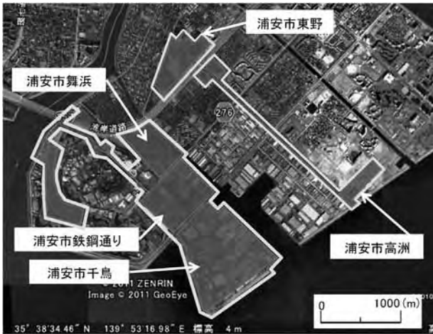
図-7 浦安市の調査範囲と液状化地点 (Google Earth を利用)
