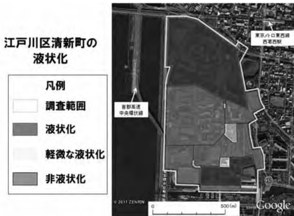
図-5 江戸川区清新町の液状化地点 (Google Earth を利用)
