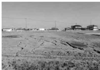
写真-34 農地での噴砂の堆積
