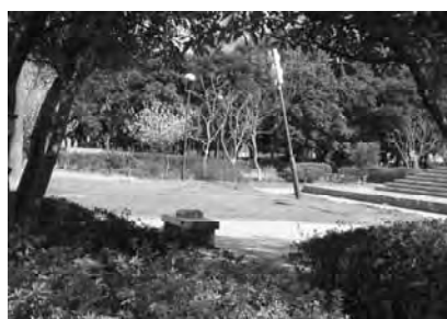
写真-13 公園の噴砂と街灯の傾斜
