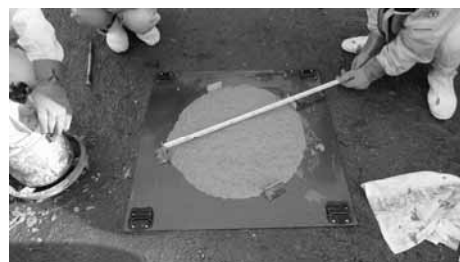
写真-9 スランプフロー状況
