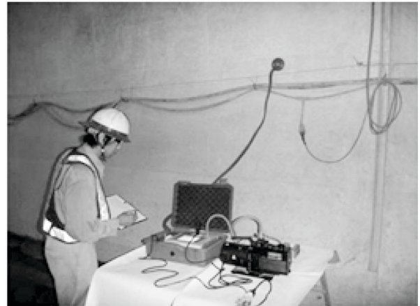
写真-3 透気試験の測定状況
