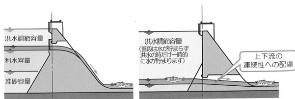
図-1 多目的ダムと治水専用ダム
