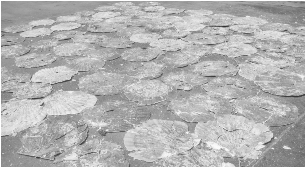
写真-4 貝殻1段で5回転圧（振動無し）
