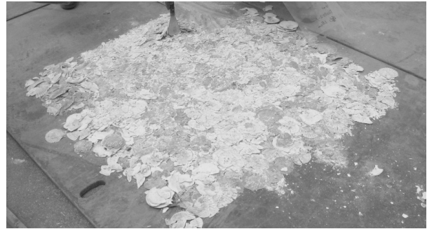
写真-7 振動ローラ(4t)による6回転圧後の貝殻の破碎状況
