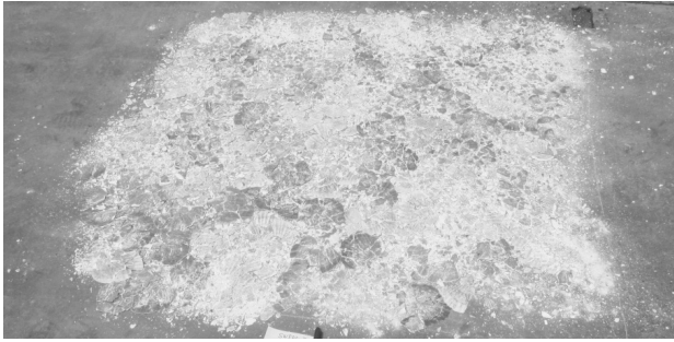
写真-5 貝殻1段で5回転圧（振動有り）
