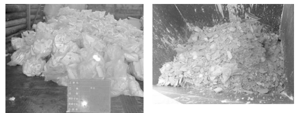
(1) 配管保温材 (2) スレート（含水状態）
