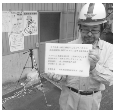
写真-13 投入設備棟入り口での大気サンプル採取状況
