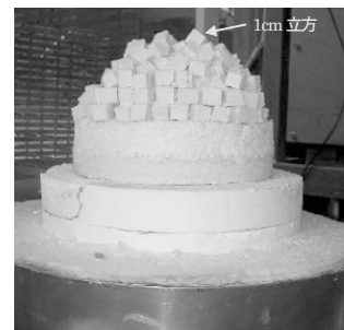
d) 1cm立方 サンプル 500個をるつぼに設置
