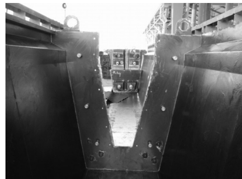
写真-3 PU-C桁用型枠
