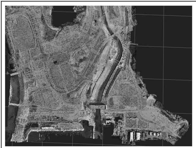
図-4 点群モデルと CAD モデルの重ね合せ
