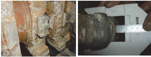
写真-3 「低」摩耗検知ビット
