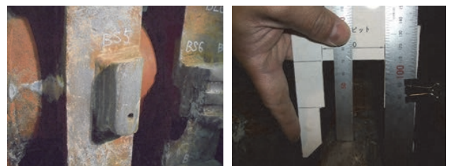
写真-2 「高」摩耗検知ビット
