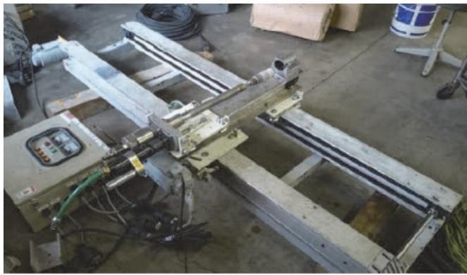
写真-1 移動架台付き WJ 削孔装置 (全体)
