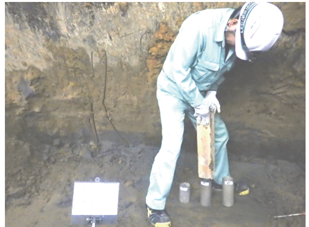
写真-3 函内不攪乱試料採取状況(採取器の静的圧入)
