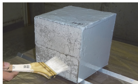
写真-1 供試体への表面含浸材の塗布状況
