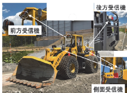
写真-2 重機への受信機取り付け位置
