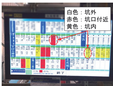
写真-1 入坑管理システムモニタ
