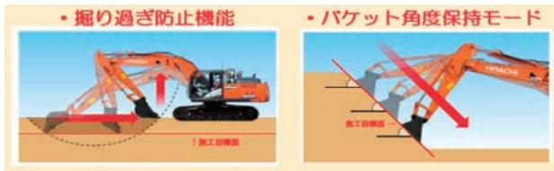
図-3 ICTバックホウの仕上がり精度を確保する機能
