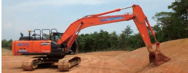
写真-2 マシンコントロール機による丁張レスでの作業
