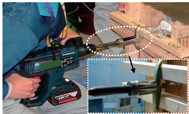
写真-3 電動ハンマによる加振状況
