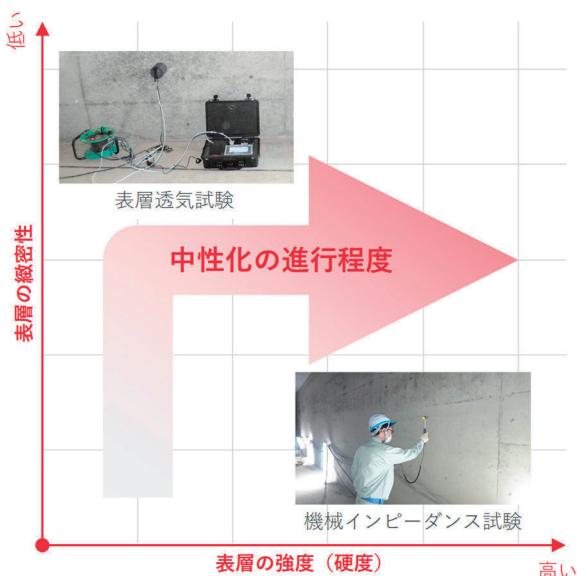
図-12 NDT 組合せ評価による中性化の進行程度の診断
