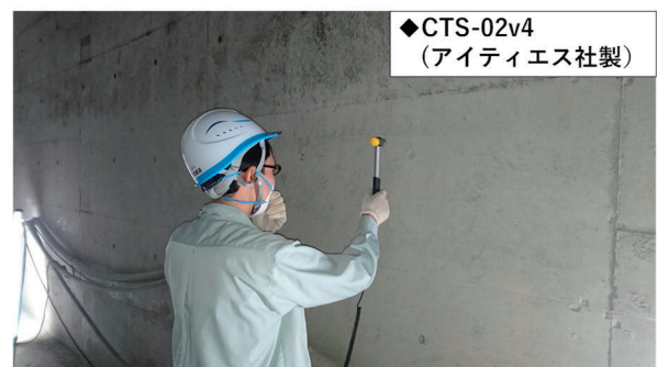
写真-3 機械インピーダンス試験
