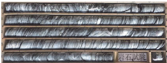
写真-1 追加調査ボーリングによるコア採取
