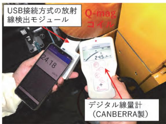
図-5 放射線測定状況の一例
