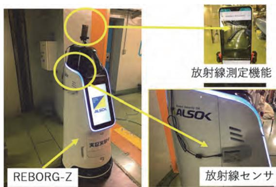
図-6 REBORG-Zによる放射線測定状況の一例
