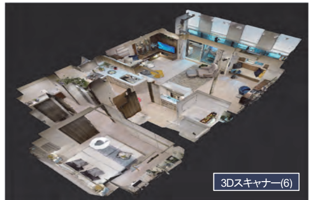
図-3 3Dスキャナーにより作成した3Dデータ
