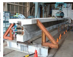
図 - 6 実規模試験体の载荷状況
