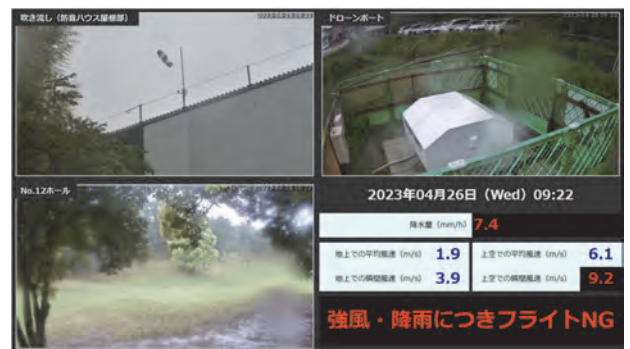
図-10 専用アプリ上での警告表示の例
