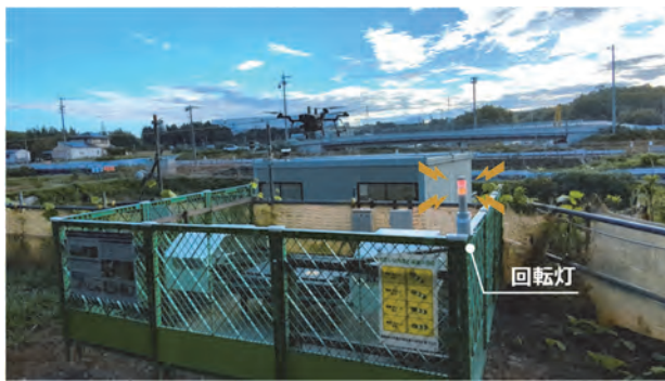
図-15 回転灯とブザーによる離着陸時の警告
