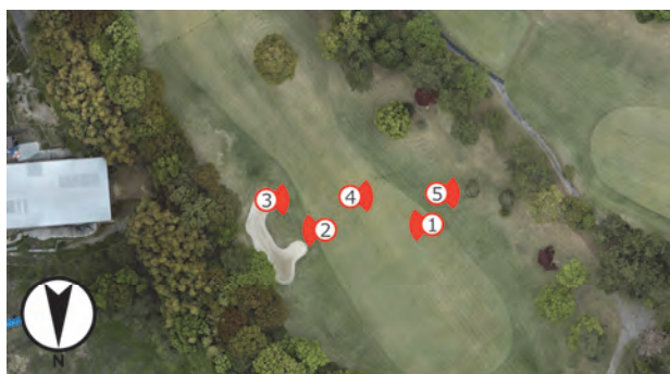
図-12 オルソマップ上への各画像データ撮影時の機体位置および方位角の描画
