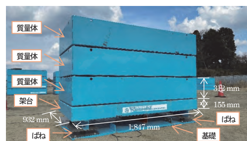
写真-2 振動系設置状況 (3段1基)
